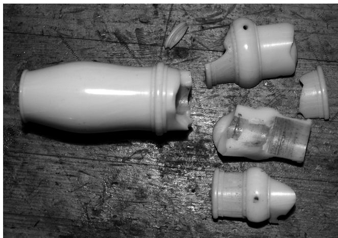
Het uit elkaar gespatte voetje van de Hotteterre-kopie. Bij de tap was het materiaal veel te dun gedraaid, wat hoe dan ook op een of ander tijdstip tot problemen zou hebben geleid.
