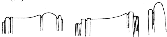
Voetje van een ivoren altblokfluit van Gahn, collectie Frans Brüggén. De bouwer heeft zich de moeite genomen de drie stukken ivoor met schroefdraadverbindingen te koppelen. De tekening is afgeleid van de set van tekeningen die Fred Morgan heeft gemaakt van de blokfluitcollectie van Brüggén.
