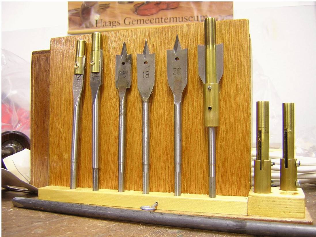
Foto: set speedboren, voorzien van opzetstukjes zodat ze een voorgeboord gat (met de diameter van het voorste deel van het opzetstukje) precies volgen.
